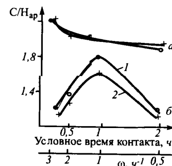
Рис. 3.16. Влияние объемной скорости подачи сырья \omega на атомное отношение C/H в ароматических структурах в целом (а) и в полициклических аренах (б) при 360^\circ\text{C} (1) и 380^\circ\text{C} (2)
